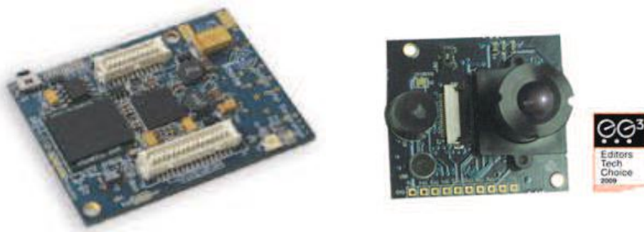
FIGURE 2.3 – Capteur Imote2 IPR2400 & Carte Multimédia IBM400
