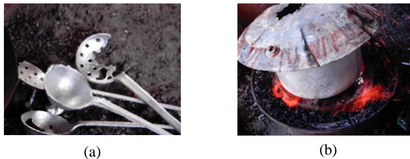
Figure 13 : Ustensiles de cuisine présentant des défauts nécessitant leur recyclage :(a) défauts observés sur des louches et des écumoirs ; (b) fusion d'une marmite ayant des défauts.
