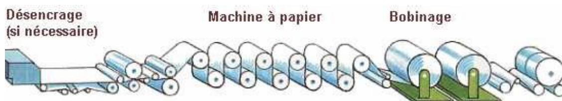
Figure 2 : 2 ème partie fabrication industrielle du papier
